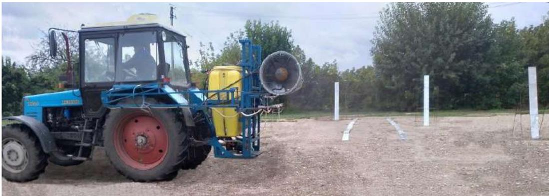
Рисунок 2 – Рабочий момент технического средства при скорости движения 3 км/ч по транспортированию капель распыляемой жидкости для их осаждения по назначению
