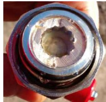
б) патрон с фильтровальным элементом внутри
