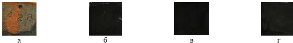
Рисунок 1 – Внешний вид стальных образцов без покрытия и с покрытием из БП, толщиной 670, 1441, 2016 мкм после экспозиции в течение 14 суток в 0,5 М NaCl
