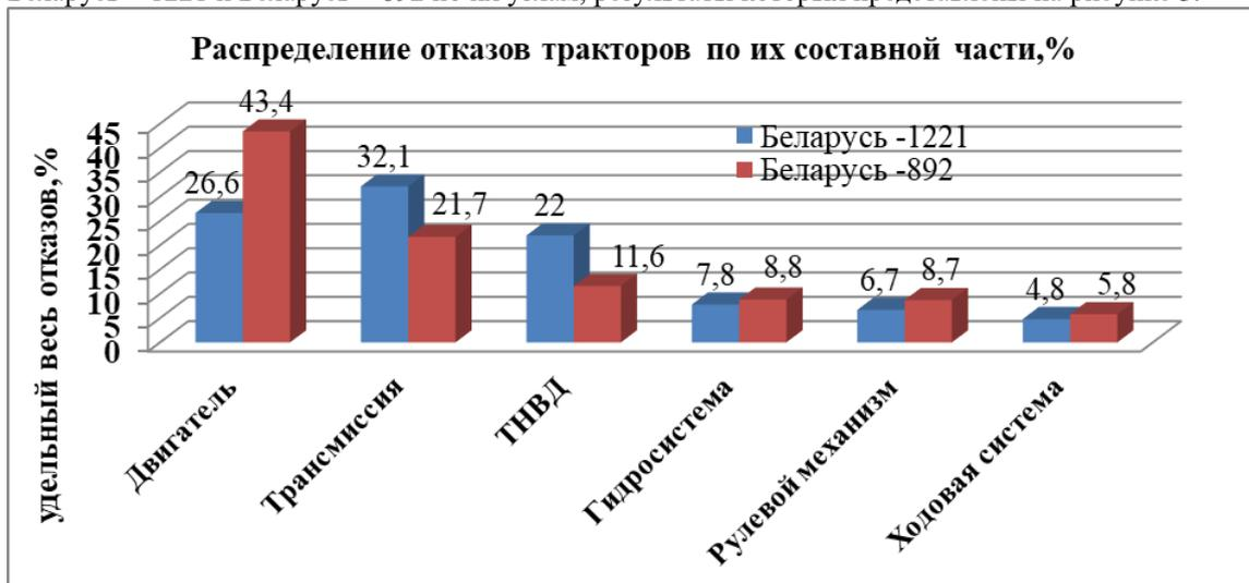
Рисунок 3 – Сравнительная распределения отказов тракторов Беларусь 1221 и Беларусь 892, по их узлам
