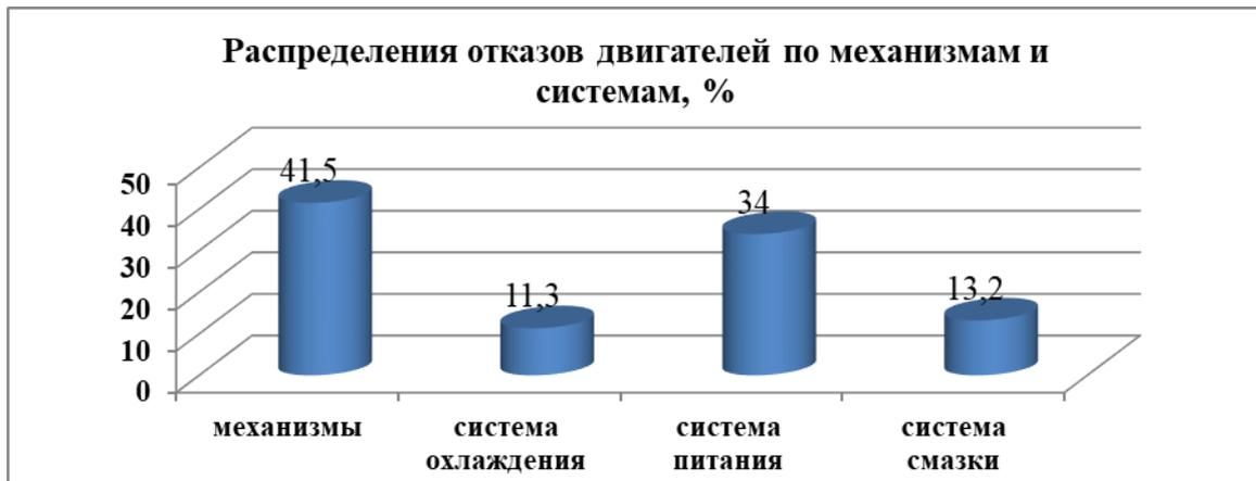
Рисунок 2 – Распределения отказов двигателей тракторов Беларусь, по механизмам и по системам
