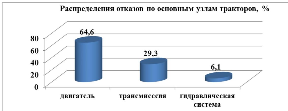
Рисунок 1 – Распределения отказов по основным узлам тракторов Беларусь
