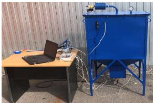
Рисунок 1 – Общий вид герметичного контейнера для хранения семенного зерна в разреженной атмосфере
