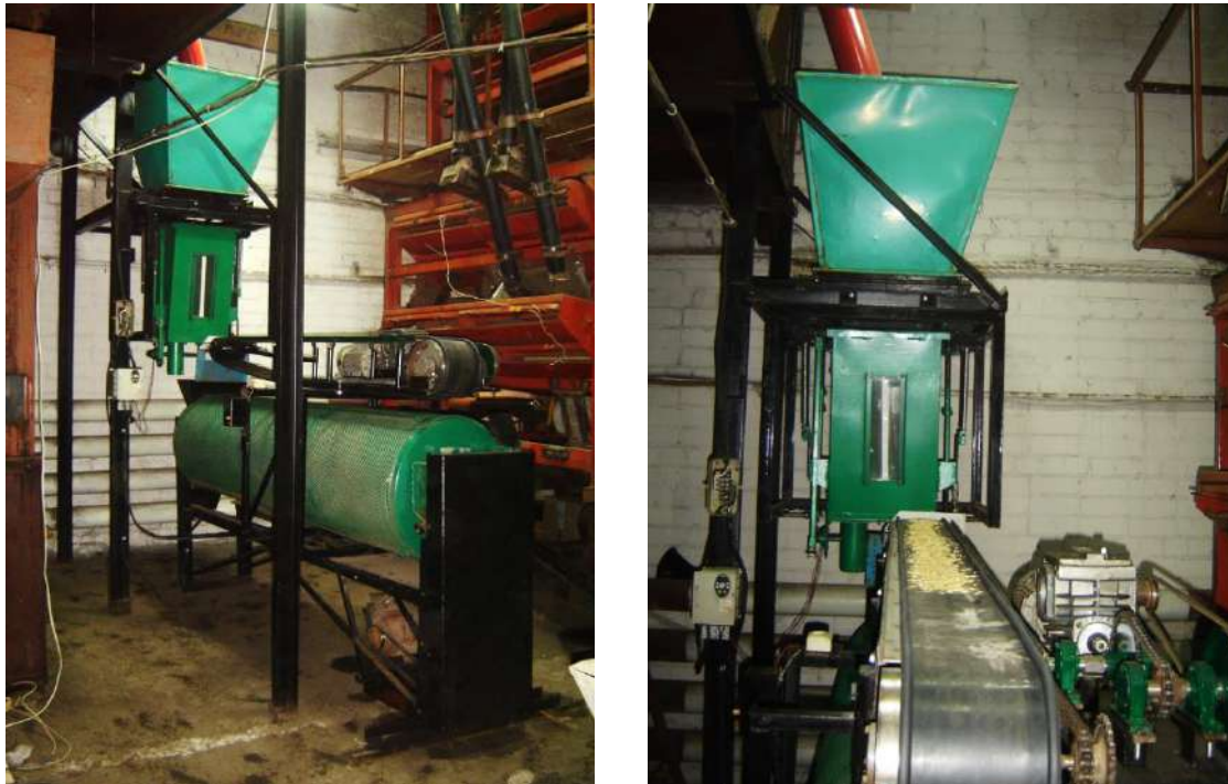
Рисунок 1 – Общий вид экспериментальной установки для исследований триерных технологий обработки зерна
