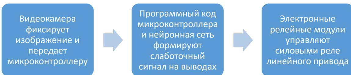
Рисунок 4 - Алгоритм работы устройства.
