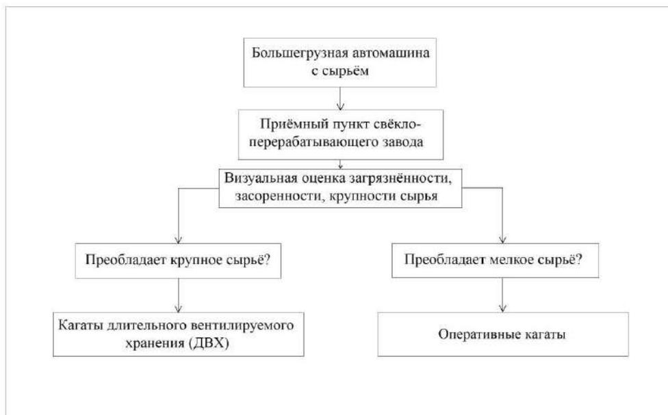
Рисунок 1 – Процесс распределения поступающего на завод сырья
