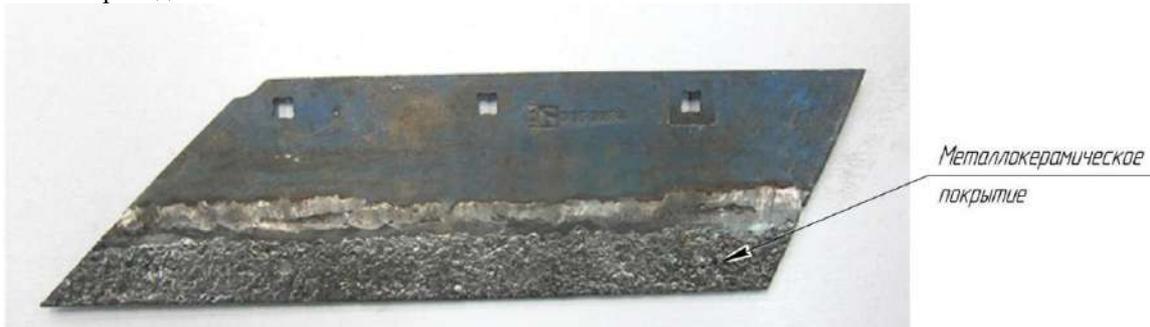
Рисунок 1 – Лемех плуга EurOpal, восстановленный привариванием КЭ с последующим его упрочнением КВДУ с тыльной стороны
