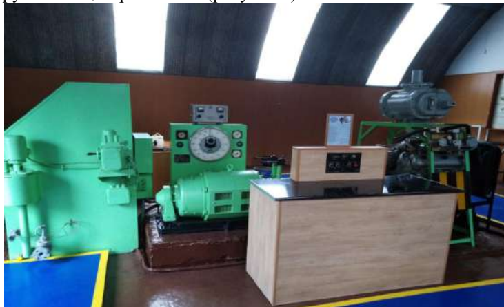
Рисунок 4 – Внешний вид нагрузочного стенда КИ-5540 и испытуемого дизельного двигателя для проведения экспериментальных исследований
