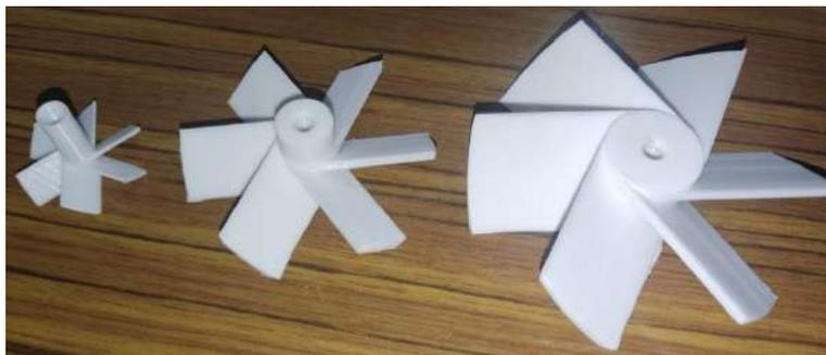
Рисунок 1 – Турбинные мешалки с наклонными лопатками различных типоразмеров
