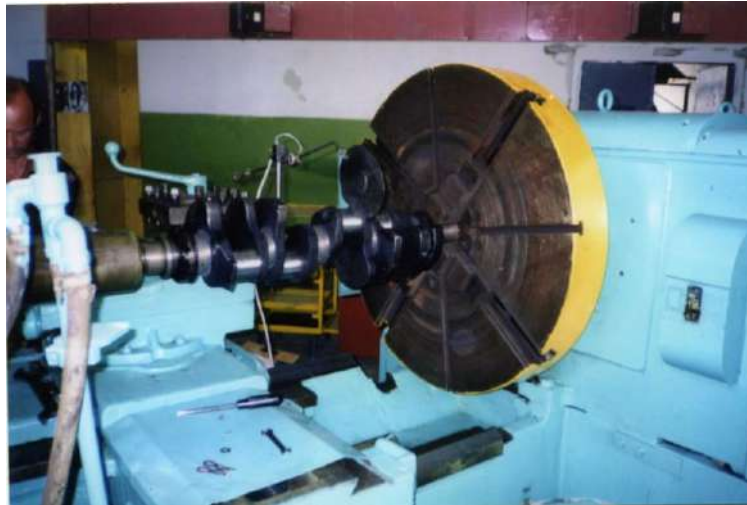
Рисунок 3 - Дискретное упрочнение коленвала двигателя КамАЗ-740
