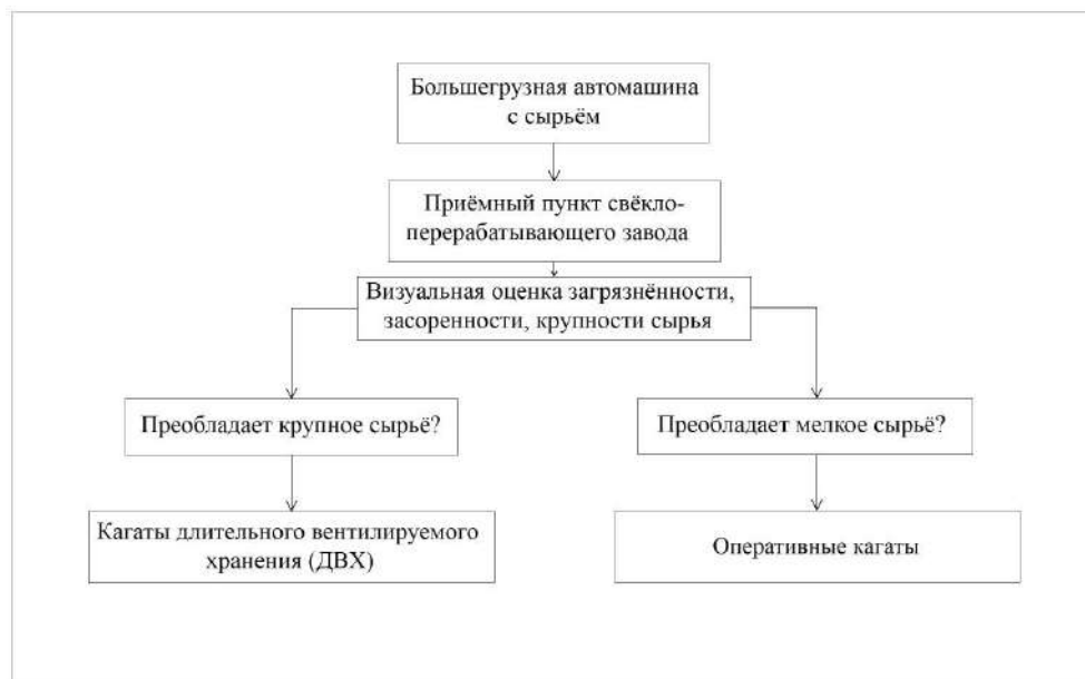
Рисунок 1 – Процесс распределения поступающего на завод сырья
