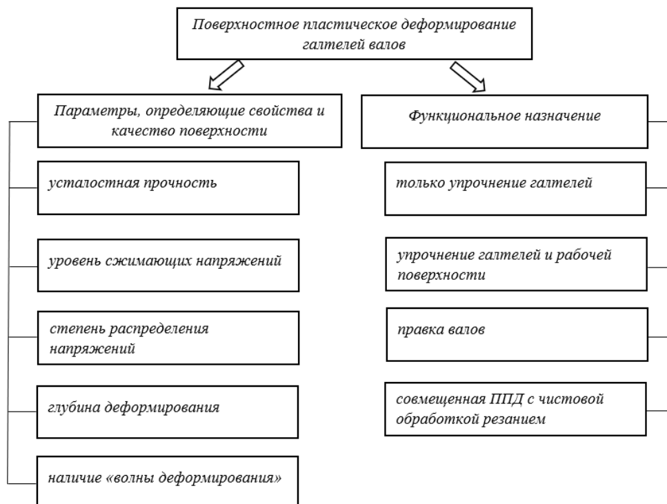
Рисунок 9 – Классификация способов ППД галтелей тел вращения
