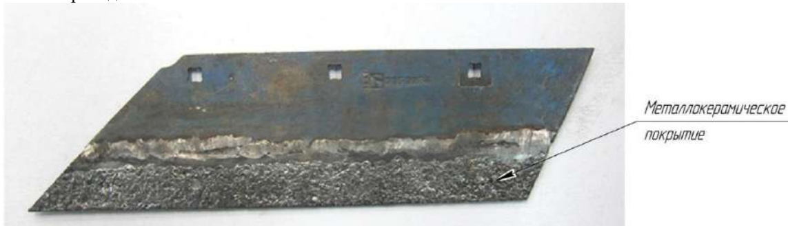
Рисунок 1 – Лемех плуга EurOral, восстановленный привариванием КЭ с последующим его упрочнением КВДУ с тыльной стороны
