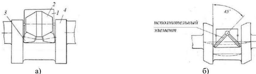
Рисунок 7 – Способы, влияющие на размерную стабильность детали: а – снижение степени коробления; б – устройство прогиба
