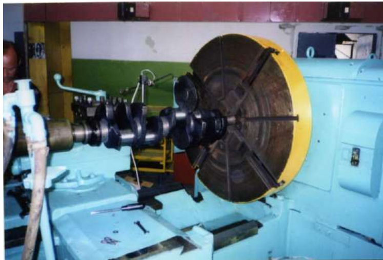
Рисунок 3 - Дискретное упрочнение коленвала двигателя КамАЗ-740
