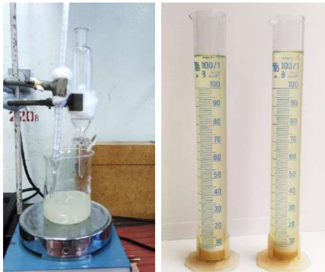
Рисунок 1 – Лабораторная установка для синтеза биодизельного топлива и внешний вид реакционной массы после отстаивания
