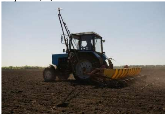
Рисунок 2 – Сеялка с модернизированными высевающими аппаратами для посева семян сои пунктирно-гнездовым способом
