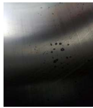
б) образующиеся в процессе эксплуатации раковины на зеркале цилиндра, как следствие работы двигателя со следами первоначальной коррозии.
