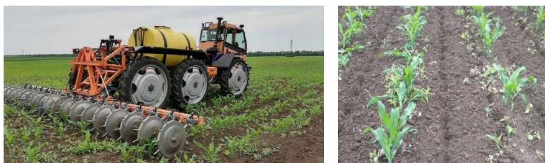
Рисунок 4 - Работа мульти-инжектора «Туман-2М» ООО «Пегас-Агро» с узкими ходовыми колесами при внесении КАС на кукурузе-а), следы от инжекторных игл в междурядьях и рядке кукурузы-б)
