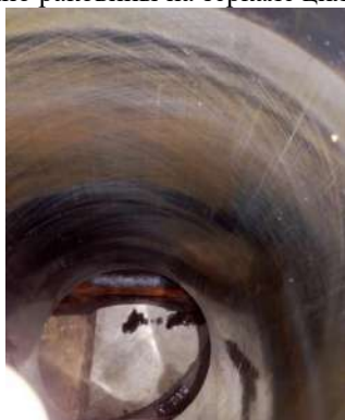
а) следы коррозии на стенках гильз цилиндров
