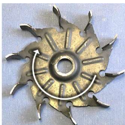
то же колесо после реконструкции для левого вращения вала генератора
