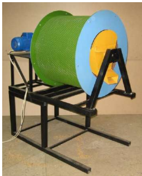
а) стенд для исследований процессов триерной очистки зерна
