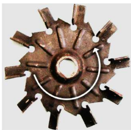
колесо с радиальными лопатками для правого вращения вала генератора
