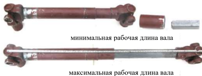
Рисунок 2 – Карданный вал Н081.02.200-16 после уменьшения длины
