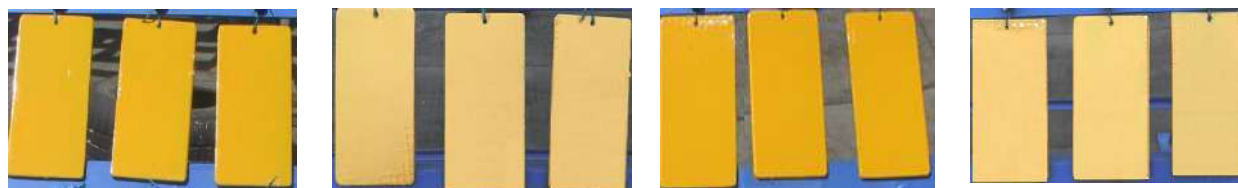
1 слой до испытаний 1 слой через 205 дней 2 слоя до испытаний 2 слоя через 205 дней Рисунок 4 – Фотографии образцов стали 0,8кп, покрытых грунт-эмалью Полиуретол в один и в два слоя
