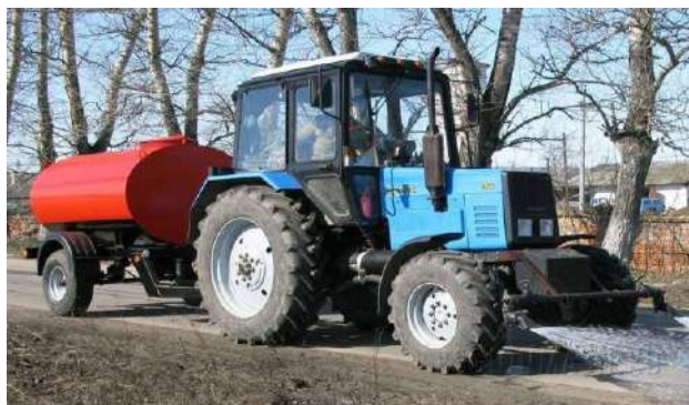
Рисунок 4 – Трактор с поливочной бочкой и работающими коммуникациями
