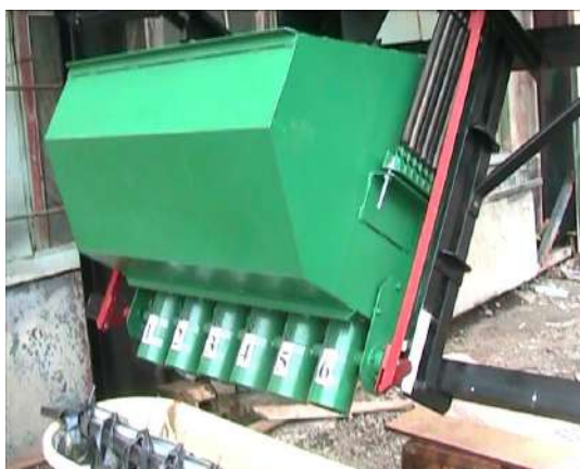
а) шестиканальный делитель наклонного исполнения с пружинной грузовоспринимающей системой
