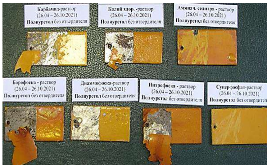
Рисунок 3 – Покрытие из Полиуретола (без отвердителя) после 180 суток экспозиции в концентрированных растворах минеральных удобрений: внешний вид и состояние металла под покрытием
