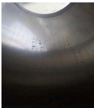
б) образующиеся в процессе эксплуатации раковины на зеркале цилиндра, как следствие работы двигателя со следами первоначальной коррозии.
