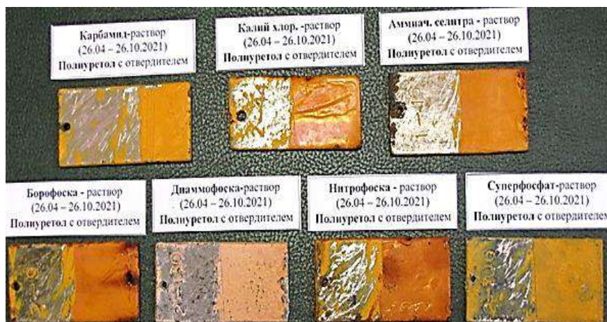
Рисунок 2 – Покрытие из Полиуретола (с отвердителем) после 180 суток экспозиции в концентрированных растворах минеральных удобрений: внешний вид и состояние металла под покрытием
