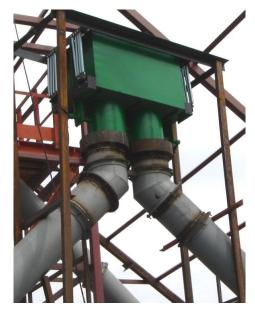
Гарантированное качество деления потока зерна обеспечивается созданием устойчивого стабилизирующего слоя зерна в регулирующей емкости, которая уравновешивается пружинной грузовоспринимающей системой. При этом отвод зерна из регулирующей емкости происходит заполненными потоками и управляется синхронными регулирующими клапанами.
