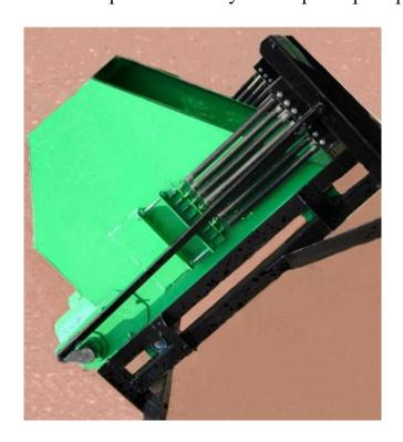
3. Шестиканальный вертикальный делитель. Используется для двухпоточной загрузки каждой триерной приставки в технологии «Новосибирскзернопроекта».
